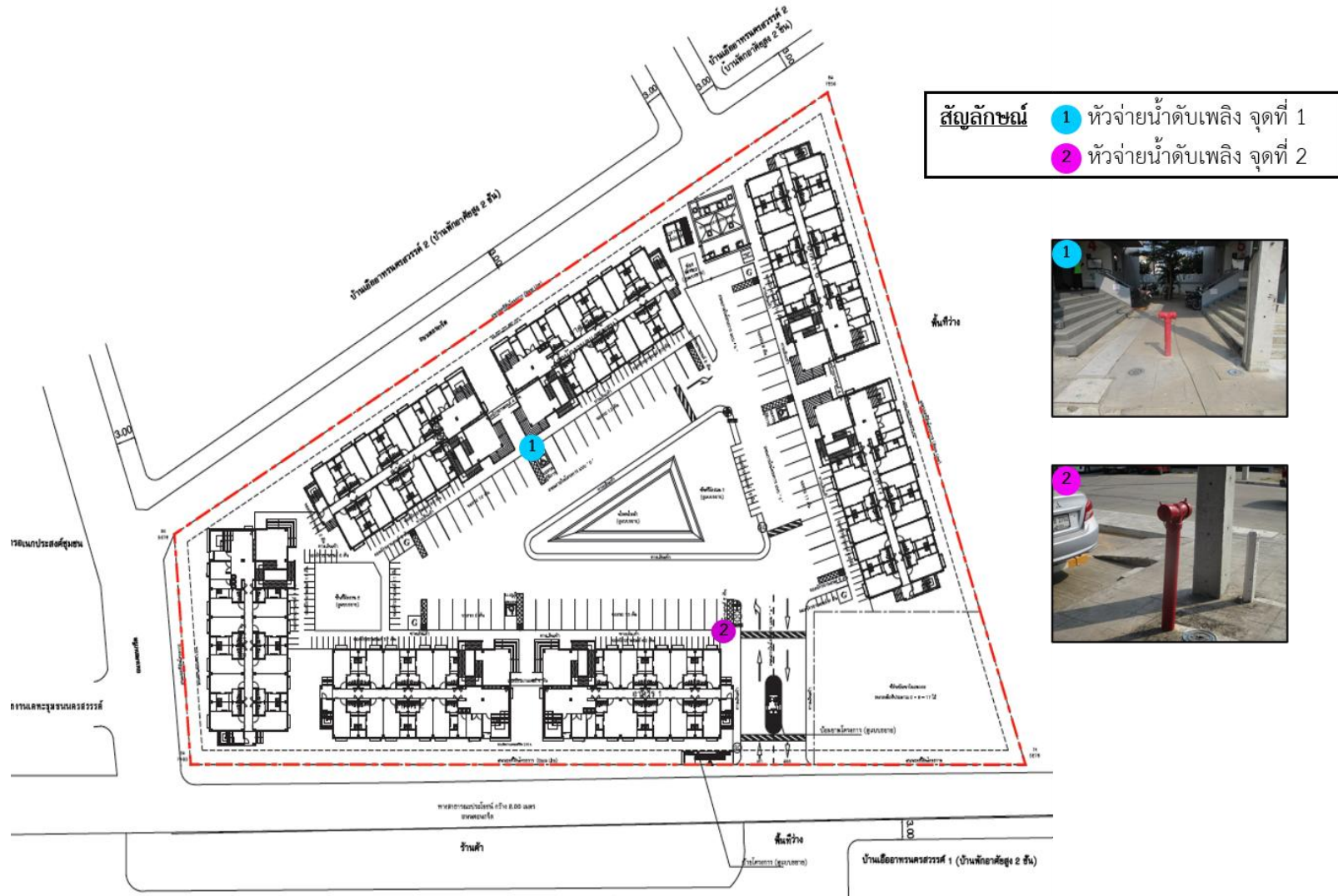
รูปที่ 2-1 แสดงตำแหน่งหัวจ่ายน้ำดับเพลิงภายในโครงการ
